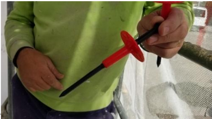
Imagen de un clavo de fijación para anclaje mediante golpeo
