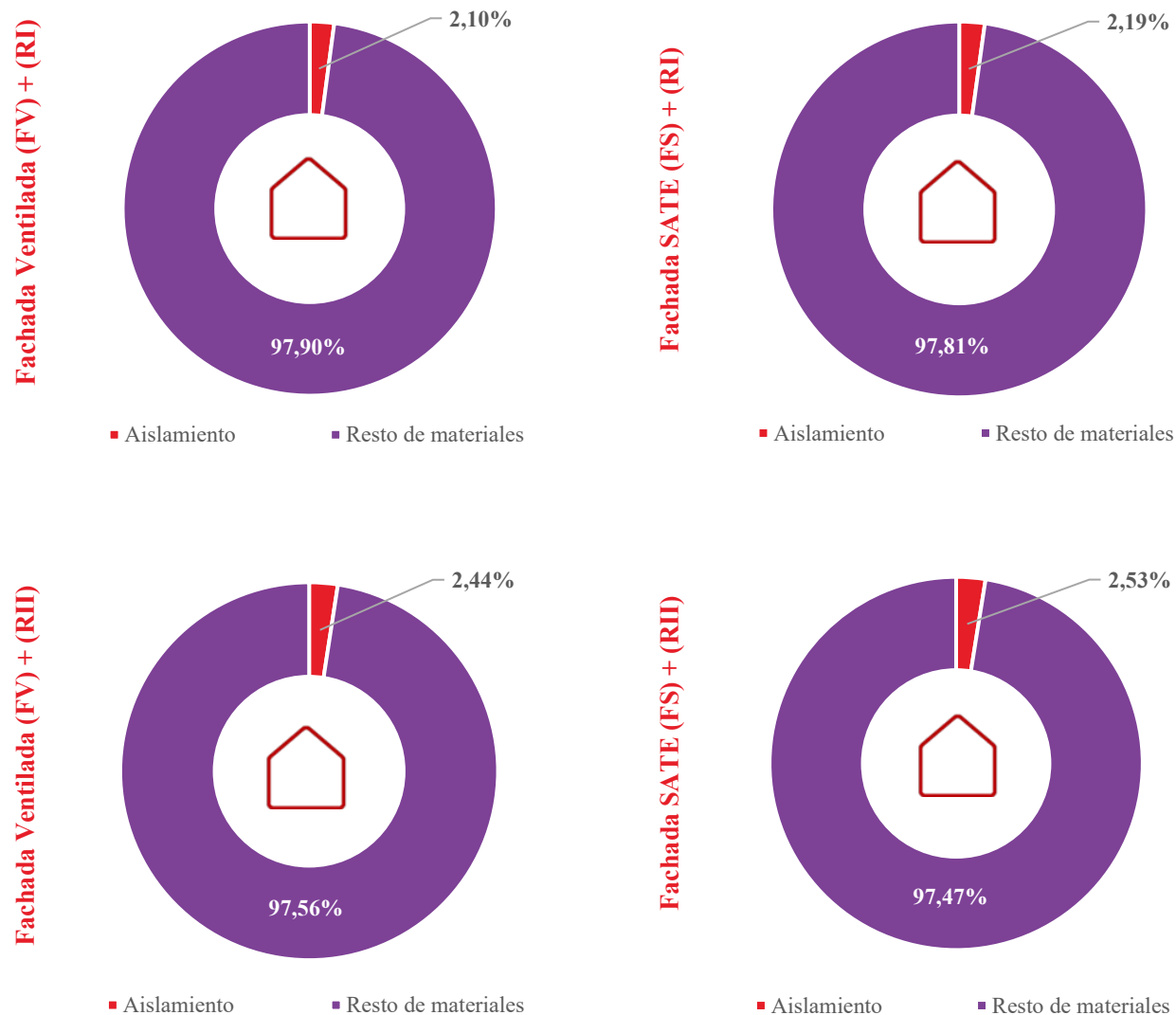
Imagen 4. Potencial de Calentamiento Global (PCG) embebido del edificio analizado, desglosando el aislamiento del resto de materiales.
