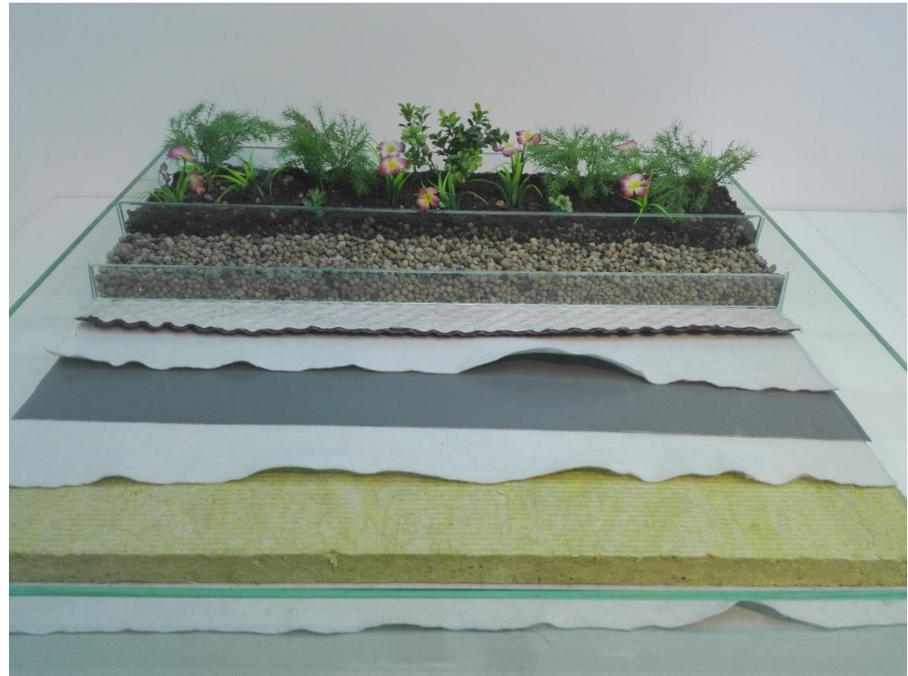
Imagen 7. Maqueta de cubierta vegetal. (En la maqueta no se muestra la capa de compresión armada)
